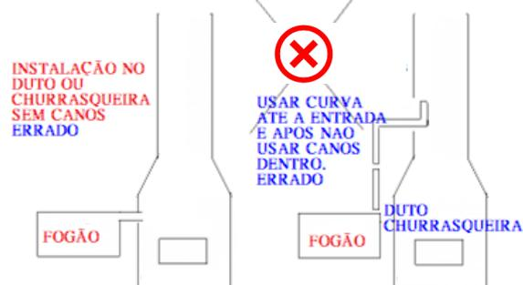
**⊗ SINAIS DE INSTALAÇÃO INCORRETA: VOLTA DE FUMAÇA, FORNINHO NÃO AQUECE SUFICIENTE, SAÍDA DE ÁGUA PELOS PÉS DO FOGÃO EM VIRTUDE DE NÃO SAIR VAPOR DA QUEIMA DA LENHA PELA CHAMINÉ, SENDO QUE O VAPOR PERMANECE NO FOGÃO, O LÍQUIDO SE TORNA PRETO DEVIDO A MISTURA DE FULIGEM ISSO TUDO É OCASIONADO PELA MÁ INSTALAÇÃO.**
